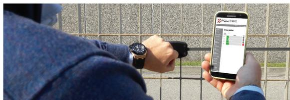
L'Adebuss peut être connecté en réseau en permettant une gestion et configuration à distance via Internet et par logiciel au moyen du programme gratuit Gapid Explorer. Ce service, accessible aussi d'un smartphone, est très pratique en alternative à la configuration à distance: l'opérateur peut facilement configurer les zones en champ simplement en "tapant" sur les capteurs.
